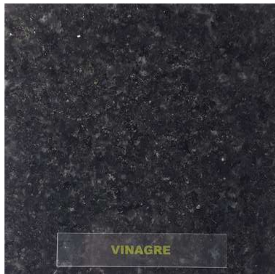
Figura 18 – Muestra “Granito Preto São Gabriel” (LMPC n.º 647-22) – superficie pulida, después de la exposición al vinagre y una operación de limpieza.
