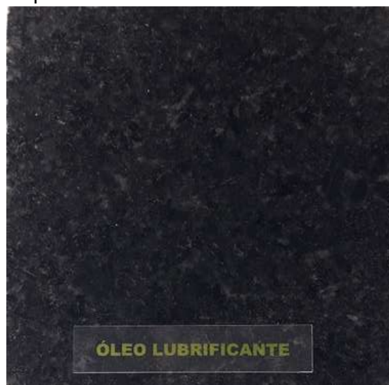
Figura 19 – Muestra “Granito Preto São Gabriel” (LMPC n.º 647-22) – superficie pulida, después de la exposición al aceite pulido, después de la exposición al vino lubricante automotriz y una operación de
