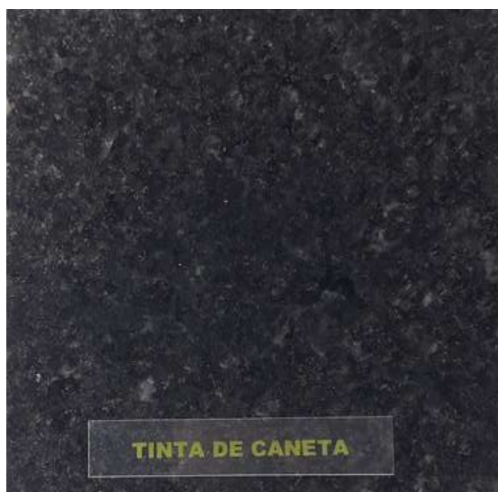
Figura 24 – Muestra “Granito Preto São Gabriel” (LMPC n.º 647-22) –superficie pulida, después de la exposición a la tinta de bolígrafo y dos operaciones de limpieza.
